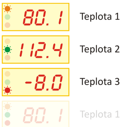
obr. 5 – způsob zobrazení více teplot na jednom displeji. Teploty na displeji rotují automaticky po třech sec. Pro identifikaci teploty slouží kontrolky po straně displeje.
