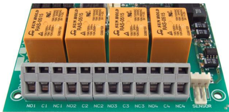
obr. 17 – přepínací kontakty výstupních relé
