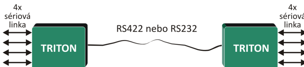
obr. 3 – On-line přenos čtyř sériových linek přes RS232 nebo RS422
