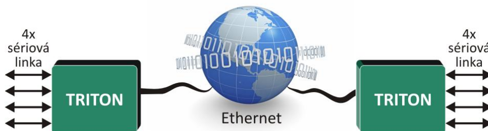
obr. 2 – On-line přenos čtyř sériových linek přes Ethernet
