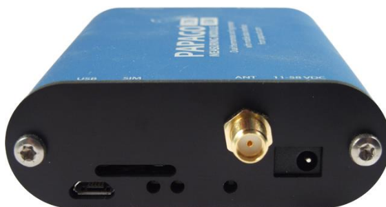
obr. 1 - štěrbinu pro SIM, konektory pro anténu, napájení a USB
